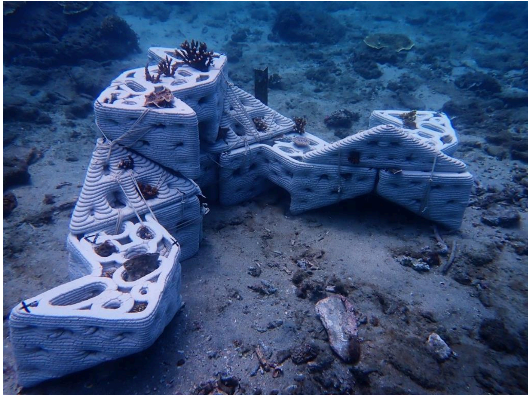
以廢棄砂矽轉換為3D列印循環生態礁，並實際於澎湖2處海域完成共6組不同造型礁體投放試驗，目前礁體已接上周邊珊瑚斷肢，後續正針對水下環境適應、生物適應性等進行觀測。（博藤海洋生技提供／許逸民澎湖傳真）
